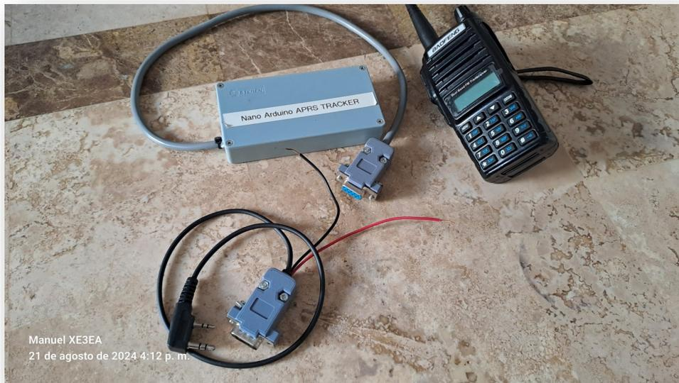
Cabe aclarar que en el gabinete de la fotografía de arriba, esta el **arduino nano** y el **GPS**. Otro detalle es que no trabajamos con el VOX del radio, si no que usamos el PTT, controlado por el arduino nano obviamente.
