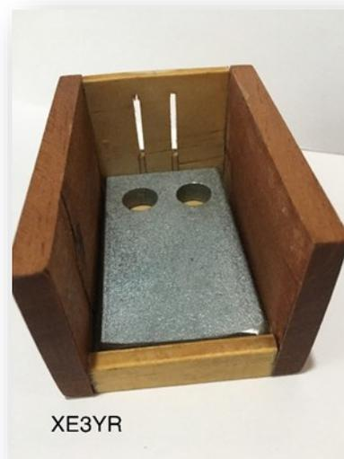
Encima de ella colocamos un pedazo de triplay a manera de aislante entre la placa y el circuito, luego el circuito que también entrará ajustado pasando las paletas a través de las ranuras
