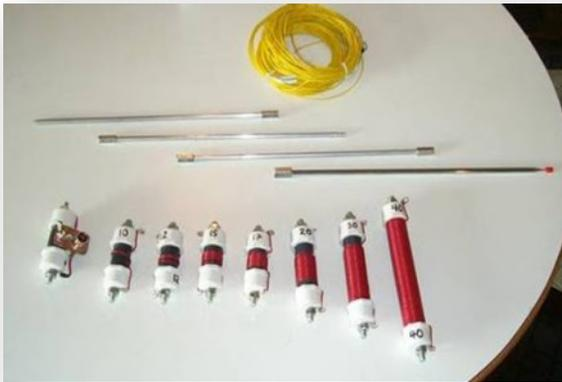
antena multibanda vertical casera con bobinas
