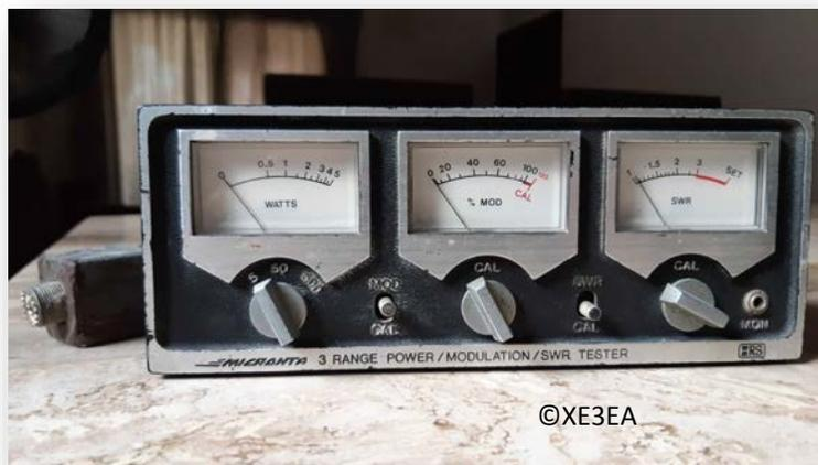
El medidor de potencia tenía 3 escalas, 5W, 50W y 500W. El medidor de SWR ya era un viejo conocido, pero el medidor de modulación era una maravilla para el radio experimentador, pues recuerden que los radios de CB de AM aun nuevos, venían con una modulación limitada.
