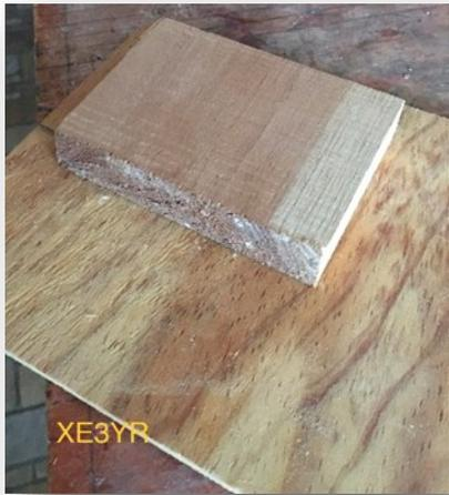
3 piezas de triplay de pino de 6 mm, cortadas a 52 x 84 mm
