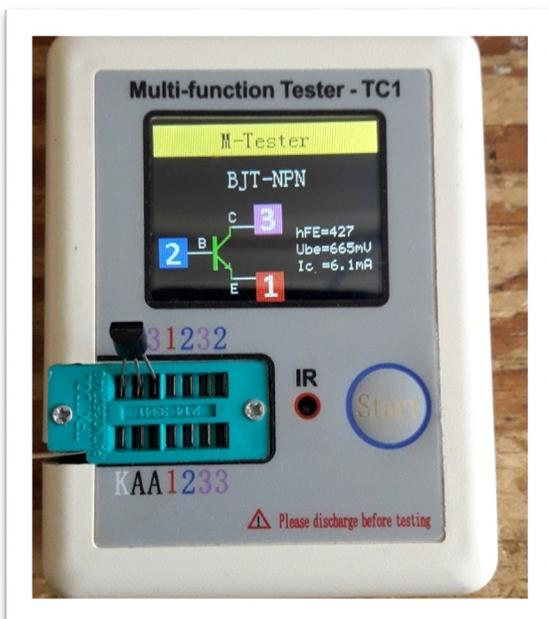
A la izquierda, puedes ver al TC1 probando un transistor C548 y te indica en que patita está el Colector, Emisor y Base y que es NPN, además te da otros datos como el hFE
