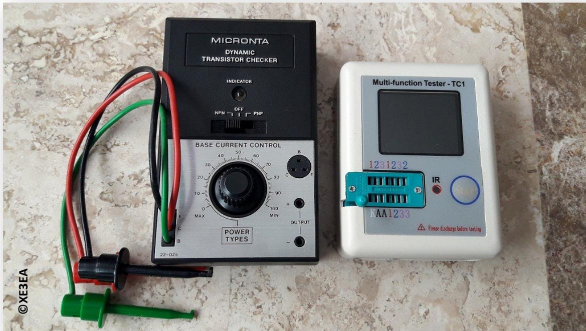
En la fotografía de arriba, puedes ver dos generaciones de probadores de transistores completamente distantes en el tiempo, el de la izquierda solo te prueba transistores bipolares, o sea o PNP o NPN. Obvio que por el nombre ya sabes que es de una muy conocida tienda Norteamericana. A la derecha tenemos un juguetito Chino, que no solo prueba transistores.
