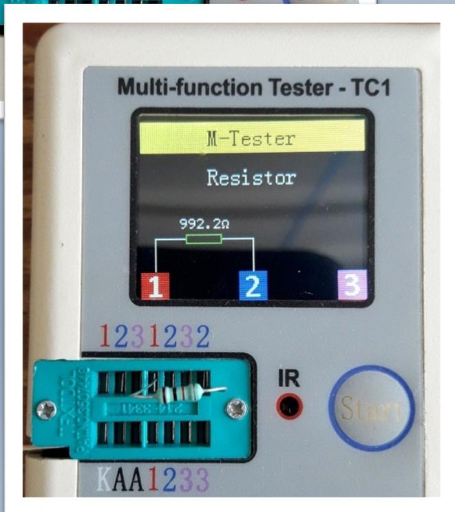
Prueba de una resistencia de 1000 ohms
