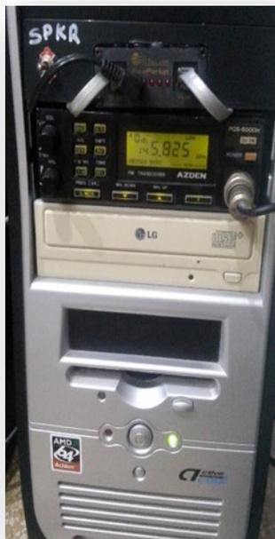
Mi primer SatGate, como se veía en Marzo de 2019, radio Azden PCS6000H, modem PaCom PicoPacket, PC con Windows Vista... muy poco tiempo después, construiría mi primer RASPIGATE, un iGate basado en Raspberry pi.
