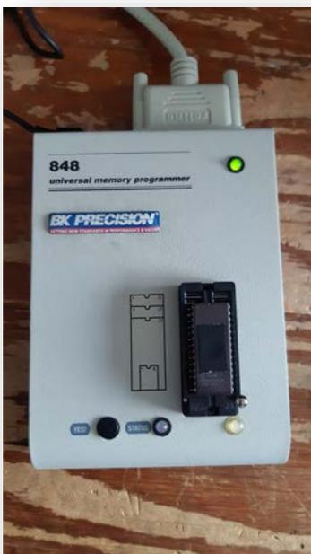
Luego se cargo el programa al EPROM como se muestra en la fotografía de la izquierda. Después de esto, el trabajo esta concluido y listo para se utilizado. Frecuencia: 50.054 Mhz
