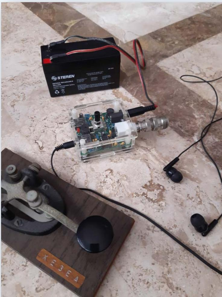
El 24 de Febrero del 2020, hice mi primer QSO en CW con este QRP con la estación de RON K7RJ. Este QRP de tan solo 0.5W y una antena dipolo me sirvió para dicho contacto. Ron me indico que la señal era muy baja, pero clara.
