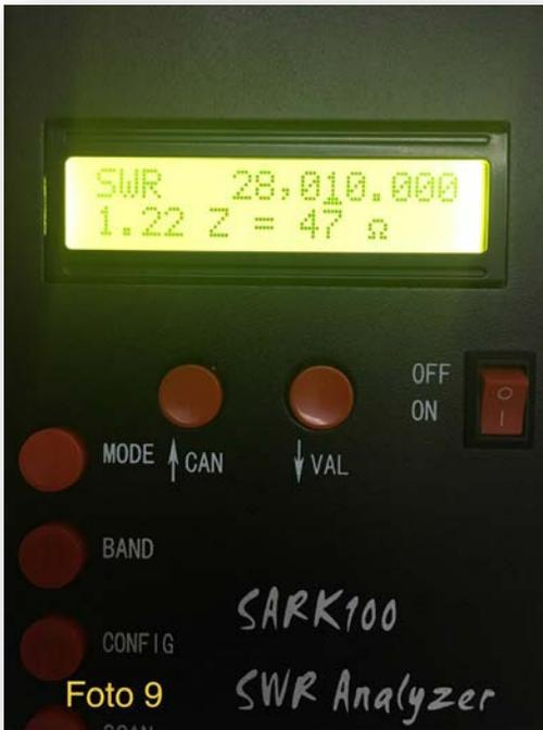
Para 10 metros, resonó en 28.010 MHz, con una impedancia de 47 ohms y una reactancia de 46 j0.
