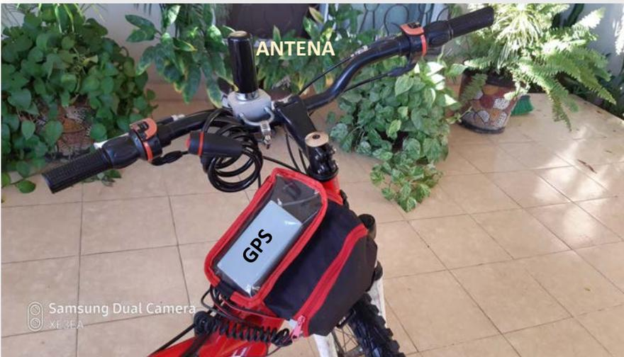
En la foto de la izquierda ves la bolsa multi compartimientos donde se colocaron la batería STEREN de 12V modelo BR-1201. La Antena es tipo dual band "low Profile".
